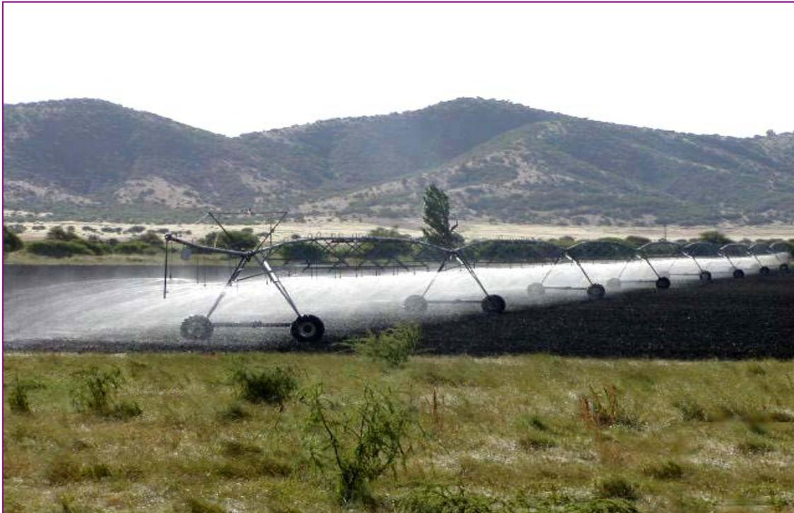
**Foto 9.5 Pivote central en funcionamiento**
